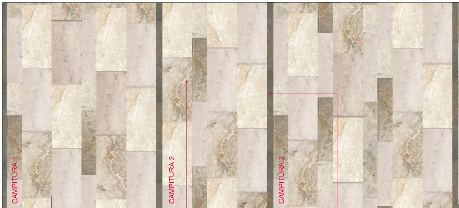
PARTICOLARE SCHEMA PAVIMENTAZIONE
