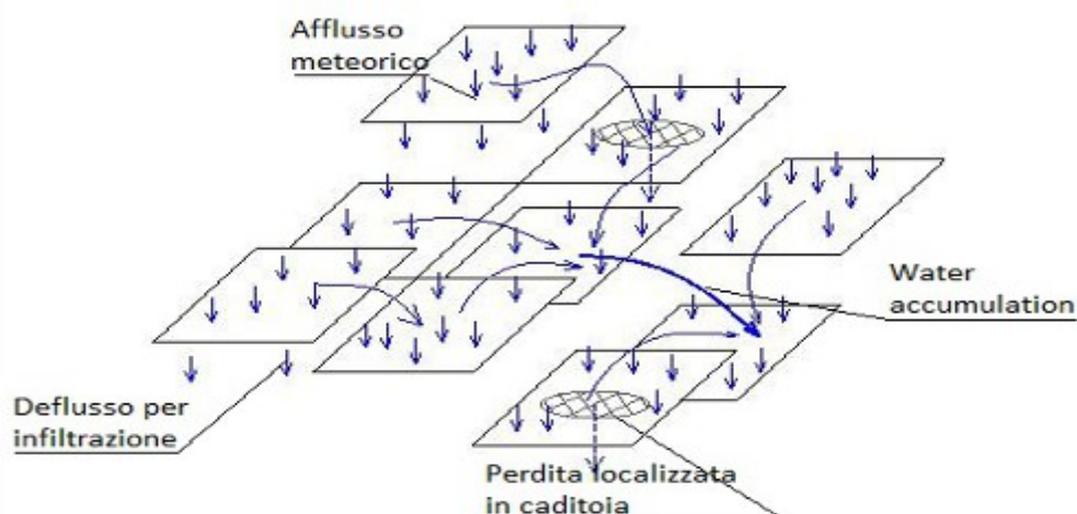
Schema di bilancio idrico a livello di cella
