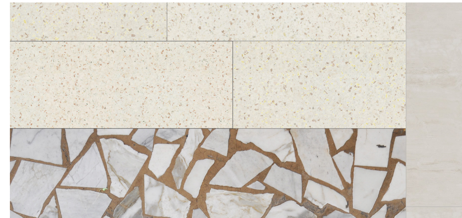
Dettaglio pavimentazione portici Lastre di graniglia a trama sfalsata con inserti di palladiane esistenti e cornice in travertino
