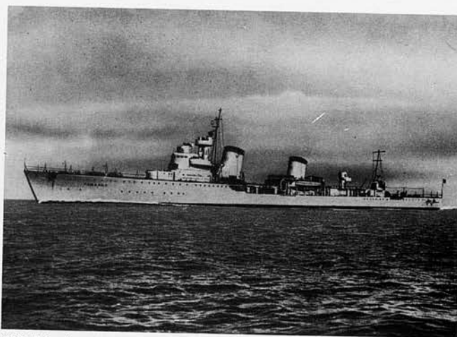
1937 - Il Cantiere Navale dimostra ancora una volta la sua elevata qualificazione con la progettazione e costruzione dell'esploratore «Taskent», commissionato dall'Unione Sovietica. Il «Taskent», che stazza 3 mila t., nel corso delle prove, eseguite nel Mar Nero, raggiunge la velocità di 45,6 nodi, rivelandosi, al momento, la nave più veloce del mondo.
